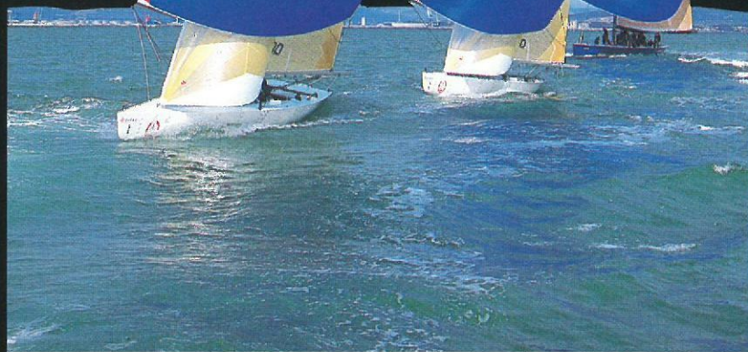
Construits à l'échelle 1/2, les bateaux-laboratoires sont des mini-Class America. Ils permettent de tester les quilles et les plans de voilure.
